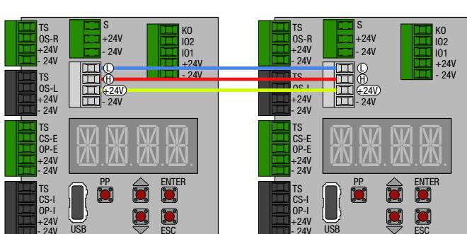
Esempio di cablaggio di 4 automazioni (caso di due gruppi di automazioni sincronizzate ed interbloccate):
