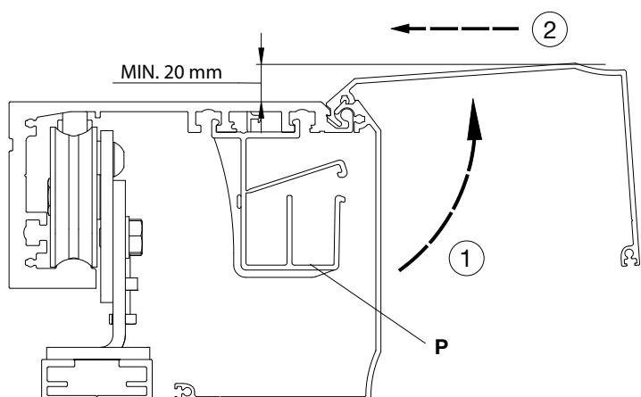
Nel caso di installazione dove non ci sia spazio ai lati per riavvitare le viti autofilettanti (installazione in tunnel), effettuare 2 fori nel cover con le misure indicate in figura, inserire il dado M6 a destra e a sinistra nell'apposita sede delle testate e, una volta chiuso, bloccare il cover avvitando le due viti M6.
