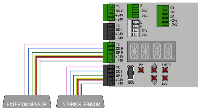
Collegare il sensore, mediante il cavo in dotazione, ai morsetti del controllo elettronico come segue:
