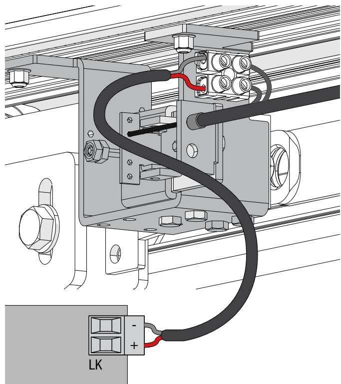
**5.4 - Collegare l'uscita dell'elettroblocco ai morsetti LK della centrale di comando.**
