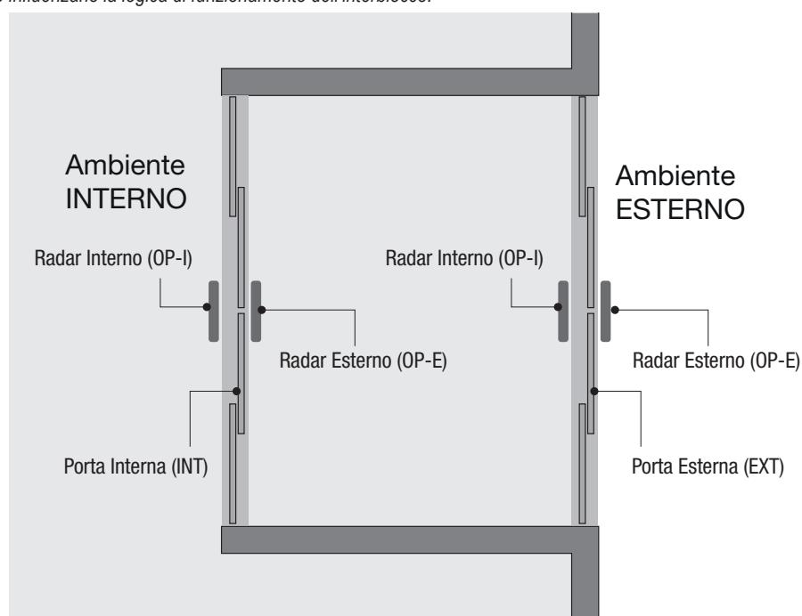
Partendo dallo stato di riposo, in cui entrambe le automazioni sono chiuse, la prima a ricevere un comando di apre avvia la manovra di apertura. L'altra automazione invece si porta nello stato 'bloccato' in cui non accetta nessun comando di apertura dai contatti OP-I OP-E. E' comunque possibile aprire (per motivi di sicurezza etc) usando il comando di apre prioritario KO.
