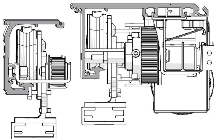
Fijar el cajón "X" con tacos de acero M6 o tornillos 6MA distribuyendo los puntos de fijación cada 500/600 mm aproximadamente.
