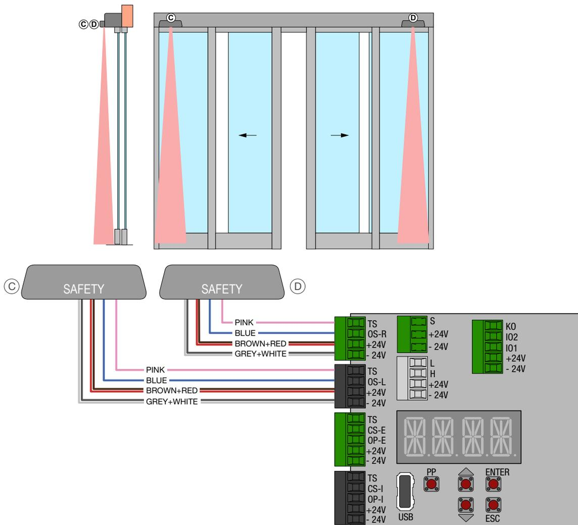
Conectar el sensor, mediante el cable en dotación, en los bornes del control electrónico, de la siguiente manera:
