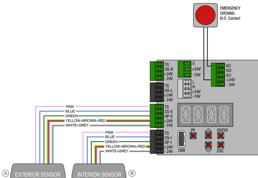
Conectar el sensor, mediante el cable en dotación, en los bornes del control electrónico, de la siguiente manera:
