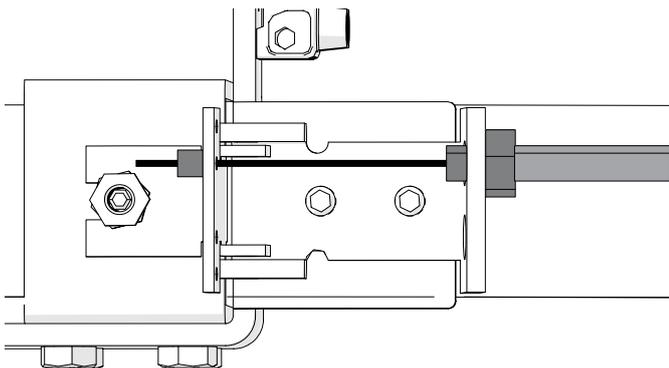
Fijar la palanca de desbloqueo en la posición deseada a través del orificio F.
