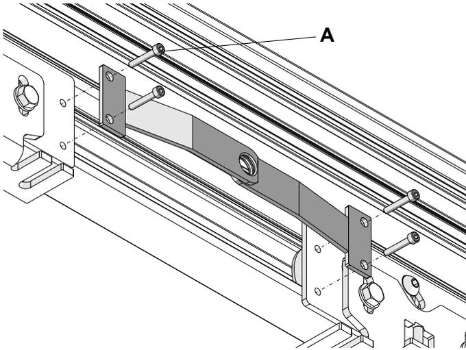
5.2 - Introducir en los lugares correspondientes los 4 tornillos de cabeza hexagonal B, de la manera indicada en la figura. Después, fijar el grupo de bloqueo eléctrico utilizando las 4 tuercas C.
