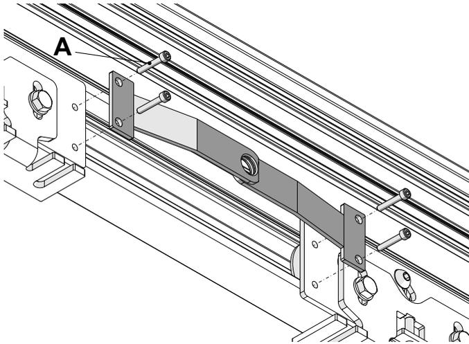
**6.2 - Introducir en los carriles correspondientes 4 tornillos de cabeza hexagonal B, de la manera indicada en la figura. Después, fijar el grupo de bloqueo eléctrico utilizando las 4 tuercas C.**
