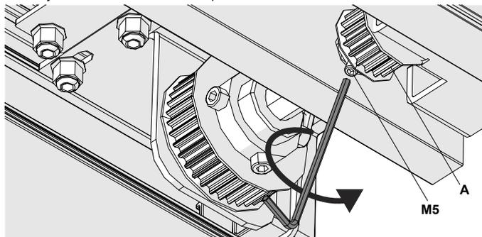
2 - Aflojar los 4 tornillos M6 y desplazar el reenvío "B" en la dirección de la flecha hasta soltarlo de la polea A.
