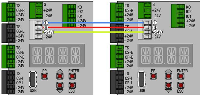
Ejemplo de conexión de 4 automatizaciones (caso de dos grupos de automatización sincronizados y enclavados):
