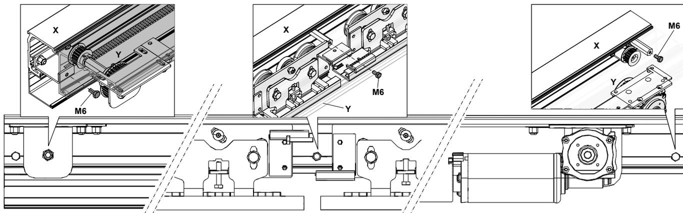
Instalar las puertas veloces "V", llevar las puertas a la posición de cierre y realizar los ajustes en altura y en profundidad ajustando la posición y solapes "S" con respecto a las puertas lente "L".
