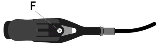
Fijar la palanca de desbloqueo en la posición deseada a través del orificio F. Ajustar la tensión del cable de acero C con la palanca L en la posición "de desbloqueo" y el estribo S girado a la izquierda completamente. Para otros ajustes actuar sobre los registros R.
