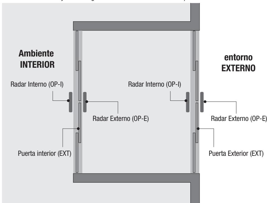
Iniciando del estado de reposo, en el que ambas automatizaciones están cerradas, la primera en recibir un mando de apertura pone en marcha la maniobra de apertura. En cambio, la otra automatización se conduce al estado 'bloqueado' en la que no acepta ningún mando de apertura de los contactos OP-I OP-E. De todas formas es posible abrir (por razones de seguridad, etc.) utilizando el mando de apertura prioritario KO.
