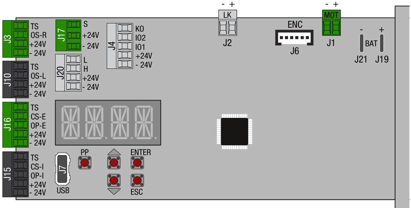
Cuando se conectan los dispositivos de seguridad quitar los puentes de los bornes correspondientes.
