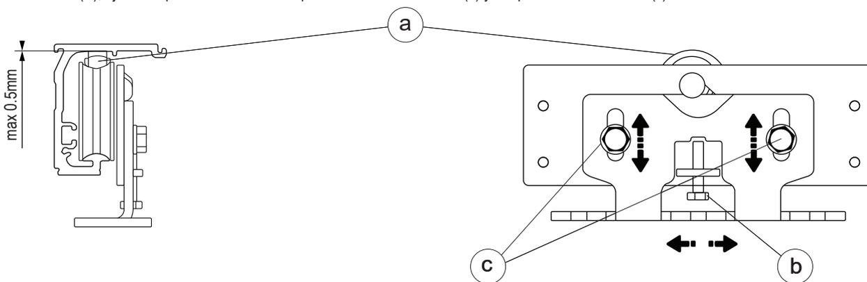
**¡ATENCIÓN!: Realizar los ajustes de manera definitiva antes de enganchar el cajón "X" en el cajón "Y".**
