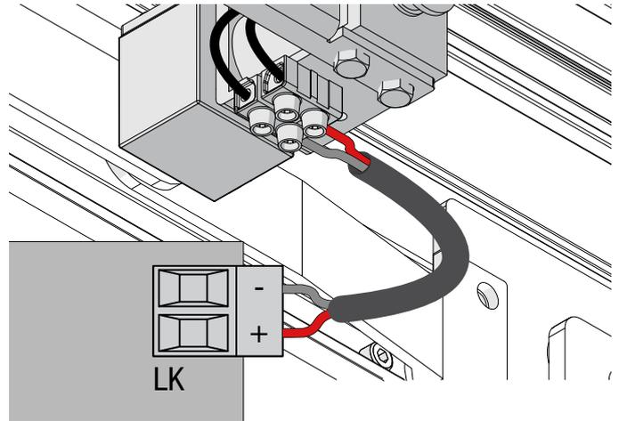
**6.4 - Conectar la salida del bloqueo eléctrico en los bornes LK de la central de mando.**
