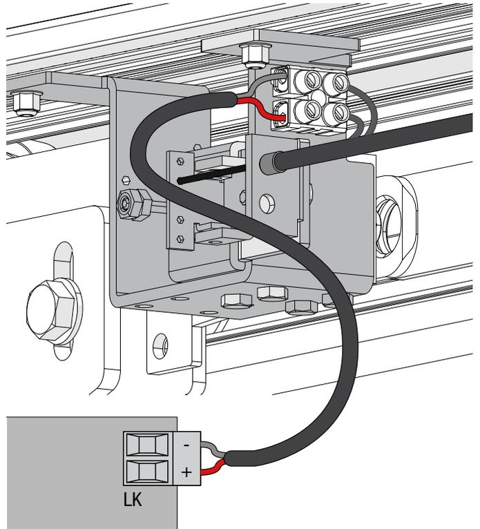
5.4 - Conectar la salida del bloqueo eléctrico en los bornes LK de la central de mando.
