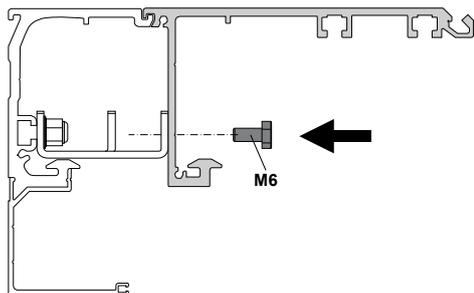
Fijarlos con los tres tornillos M6 para hacer que el cajón "Y" se una firmemente con el cajón "X".
